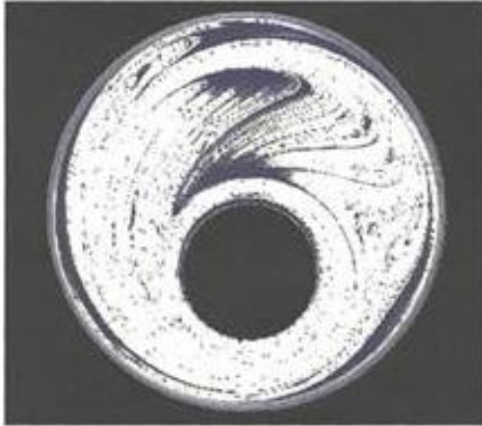
Рисунок 1— Перемішування рідини між коаксіальними циліндрами
